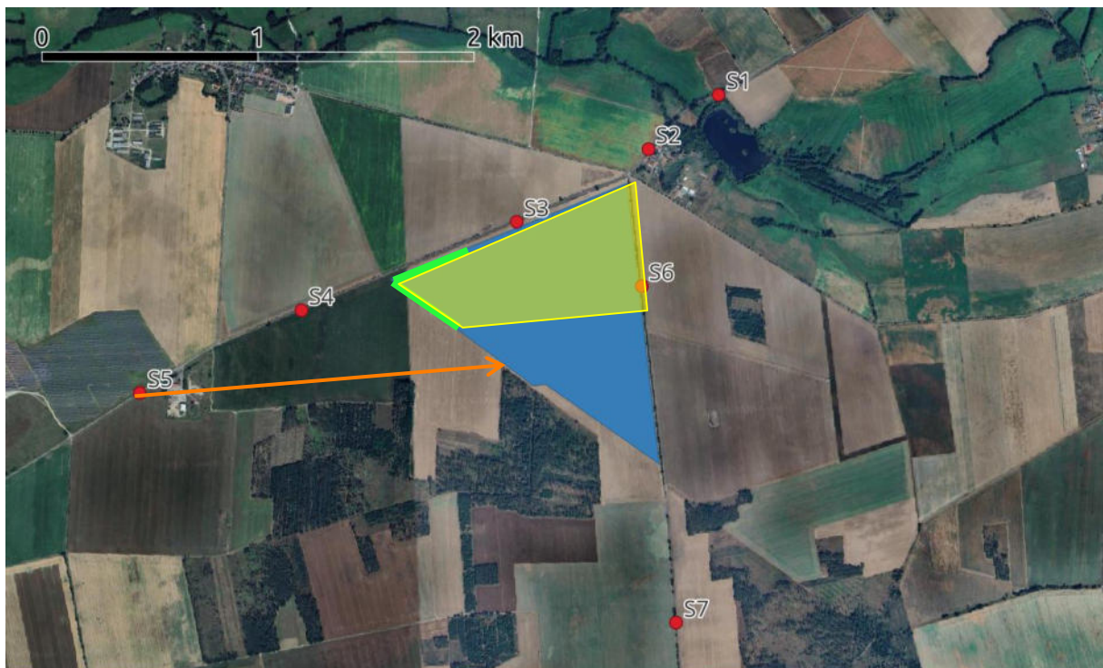
Abbildung 16: Blendsituation und Blendschutz, gelbe Fläche: Fläche die zur Blendung führt, orange: Rand des +/- 30° Sichtfeldes, grün: empfohlener Blendschutz Hintergrund: Google Earth Pro
