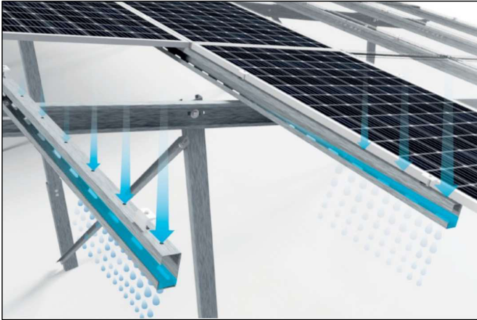
Abbildung 17: Nahansicht des Regenwasserverteilsystems
